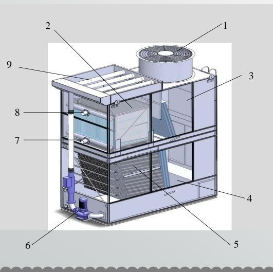
1. 风机 2. 板式换热器 3. 风腔 4 循环 水池 5.填料 6.循环水泵7.冷凝水出 口管8.蒸汽进口管9喷淋分配装置
